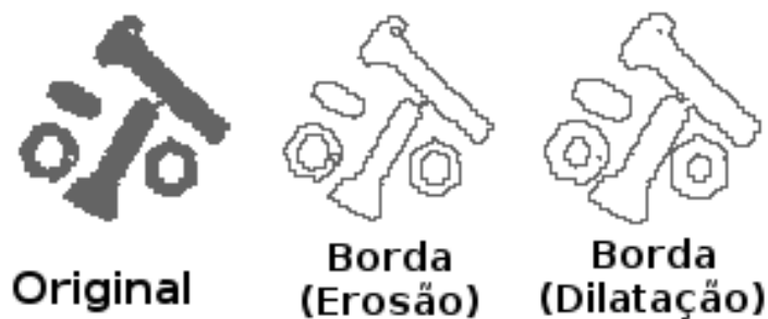
Figura 2.20: Exemplo de detecção de borda com erosão e dilatação. Adaptado de Wangenheim (2001)
