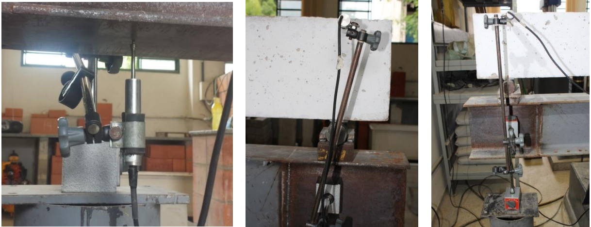
Figura 33: Detalhe do posicionamento dos transdutores de deslocamento
