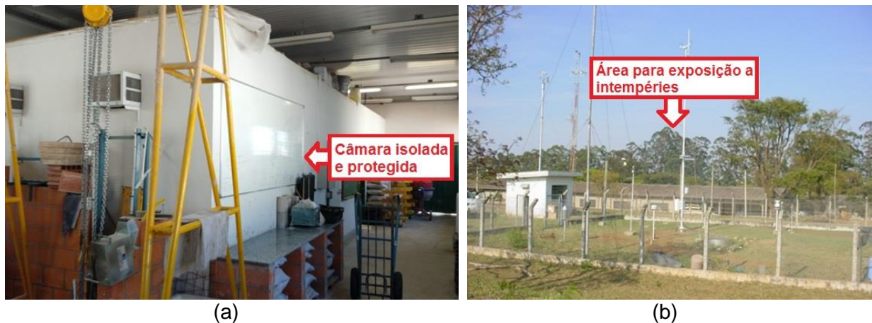
Figura 11: Ambientes de exposição: (a) câmara isolada e protegida e (b) exposição a intempéries (ambiente externo)
