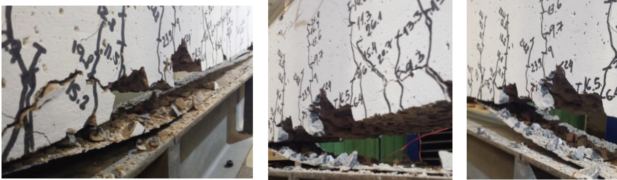
Figura 59: Modo de ruína típico das vigas reforçadas ensaiadas
