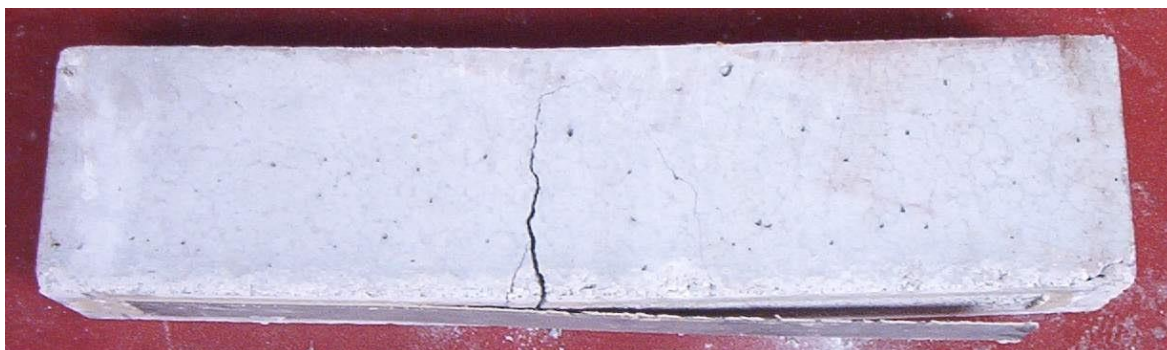
Figura 10: Descolagem prematura do sistema de reforço
