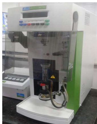
Figura 7. Equipamento para análises termogravimétricas.
