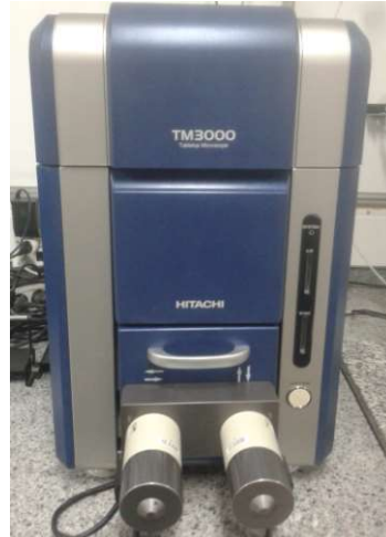
Figura 6. Microscópio eletrônico de varredura para análises de MEV/EDS.
