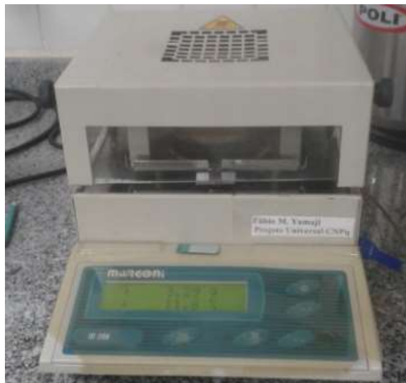
Figura 14. Balança determinadora de umidade.
