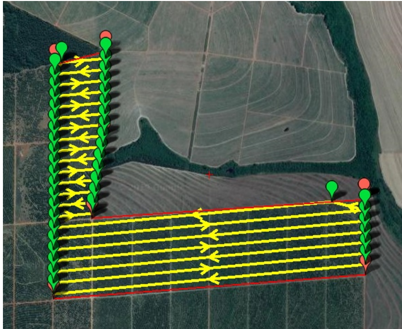
Figura 3: Exemplo de caso de área onde o movimento de boustrophedon gera excessivo número de curvas para cobrir um terreno
