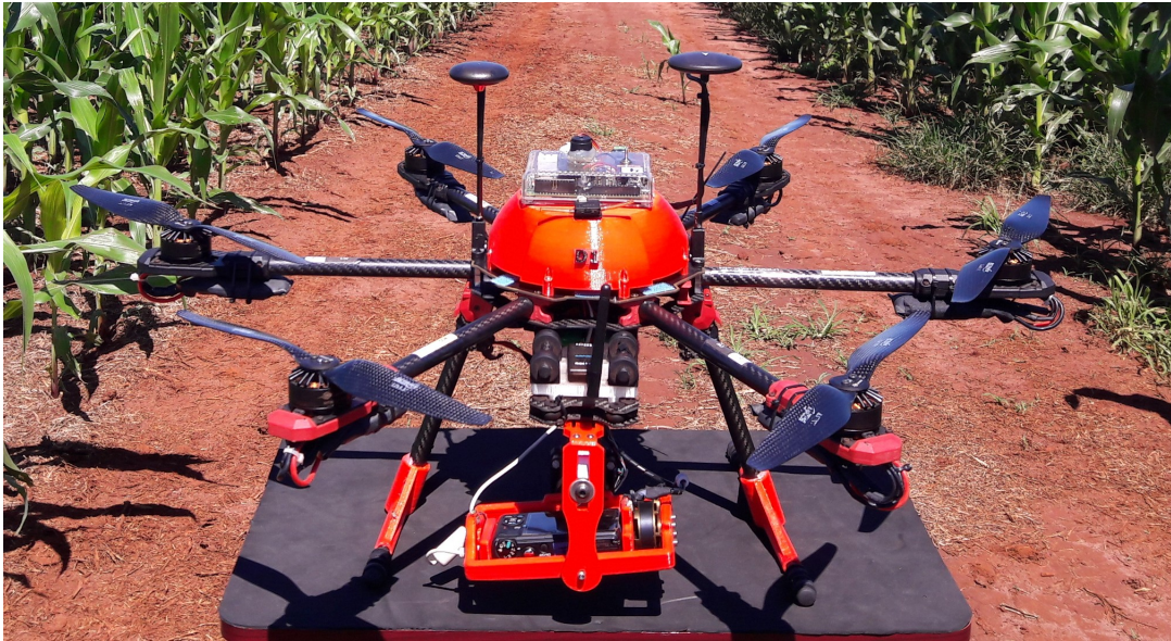
Figura 2: VANT multirotor preparado para a tarefa de aerofotogrametria
