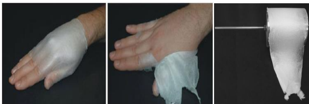
FIGURA 2.11 - Filmes de nanofibras coletados diretamente na pele e em um coletor de metal (MEDEIROS, et al. 2009).
