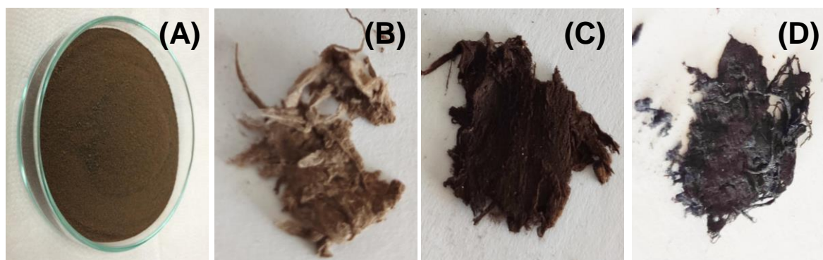
FIGURA 5.51 – Lig-C em pó e nanofibras de (PAN/Lig-C)10:90-0,2V (A) Lignina (B) Precursora (C) Estabilizada (D) Carbonizada
