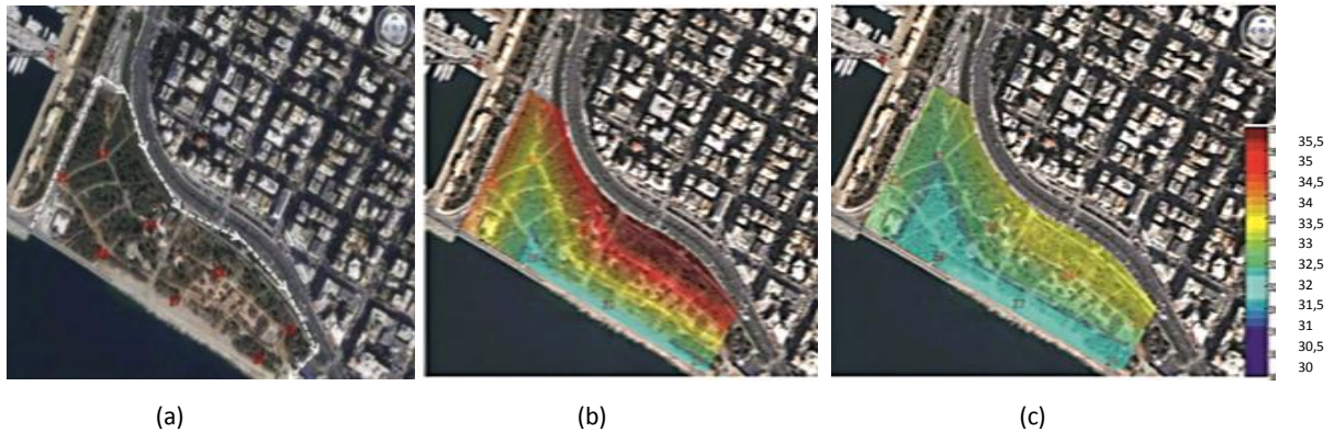
Figura 2.28. Local de implantação (a), distribuição da temperatura do ar antes (b) e após a substituição do pavimento (c).
