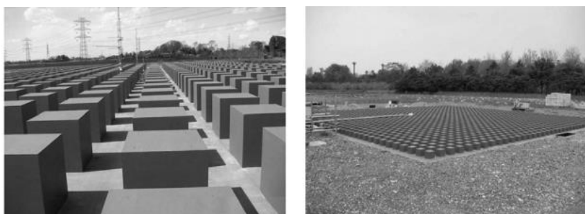
Figura 2.23. Modelo COSMO2 na escala 1:5 e 1:50 da esquerda para a direita.
