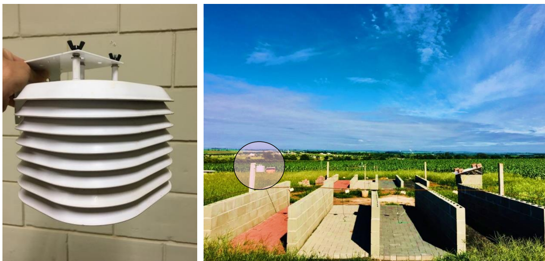
Figura 3.18. Dispositivo de proteção do sensor de temperatura e umidade relativa do ar.
