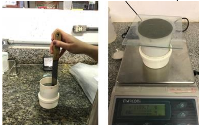
Figura 3.16: Ensaio de densidade de massa e teor de ar incorporado dos CCAD.
