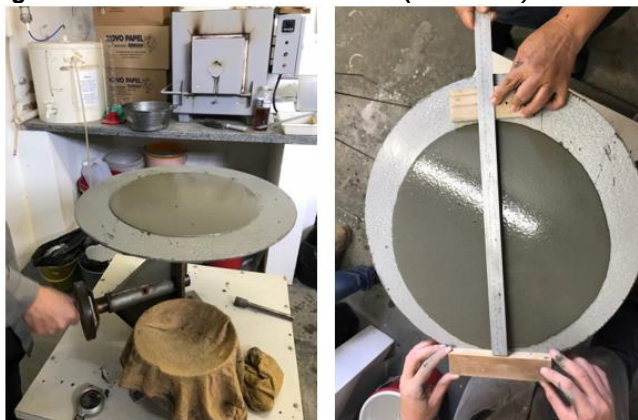
Figura 3.11: Ensaio de consistência ( flow table ) dos CCAD.
