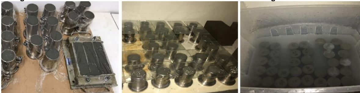
Figura 3.14: Moldes metálicos em câmara úmida e amostras imersas em água saturada com cal.
