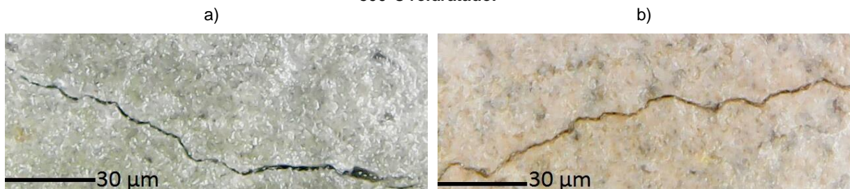
Figura 4.27: Fissuras externas dos CCAD reidratados: a) CCAD REF 800°C reidratado b) CCAD VD50 800°C reidratado.
