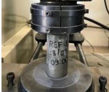
Figura 3.17: Ensaio de resistência à compressão axial dos CCAD.
