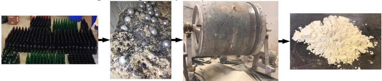
Figura 3.7: Algumas etapas do processamento do vidro.
