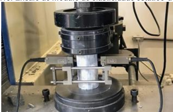
Figura 3.19: Ensaio de módulo de elasticidade estático dos CCAD.
