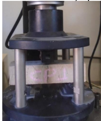
Figura 3.18: Ensaio de resistência à tração por flexão dos CCAD.
