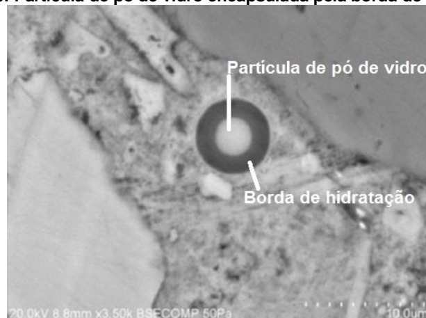
Figura 2.6: Partícula de pó de vidro encapsulada pela borda de hidratação.
