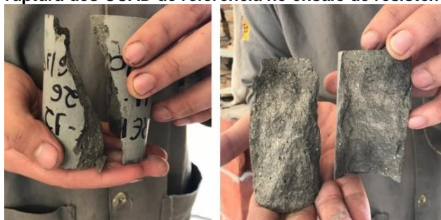
Figura 4.12: Forma de ruptura dos CCAD de referência no ensaio de resistência à compressão axial.
