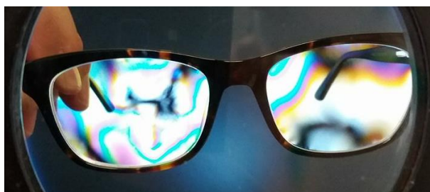
Figura 2.4 - Tensões residuais geradas pela fotoelasticidade em lentes de policarbonato observadas sob polarização cruzada. Elaborada pela autora.
