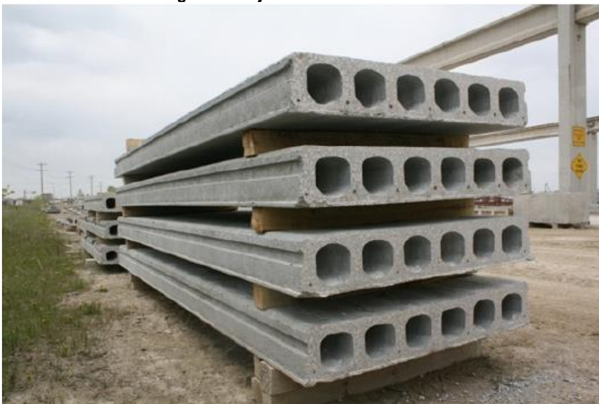
Figura 3 - Lajes alveolares estocadas
