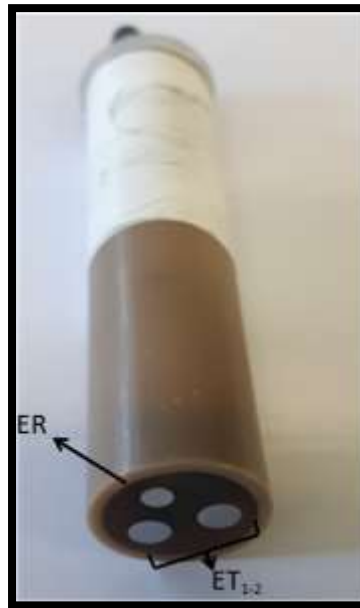
FIGURA 3.1 - Eletrodos de trabalho de aço AISI 1020 ( ET_1 e ET_2 ) e um pseudo eletrodo de referência aço inox 304 (ER).
