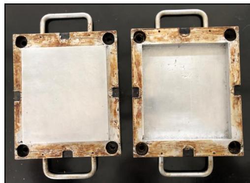
FIGURA 14 – Molde metálico utilizado na prensa hidráulica.
