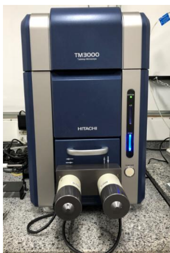
FIGURA 23 – Análise de MEV: (a) Equipamento de MEV, (b) porta amostras.
