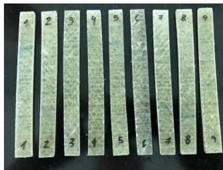
FIGURA 20 – Corpos-de-prova para ensaio de flexão.
