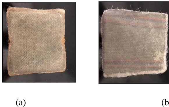
FIGURA 18 – Placas moldadas para cortar os corpos de prova para: (a) ensaio de flexão, (b) ensaio de tração.
