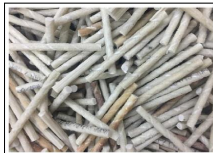
FIGURA 8 – “Agulhas” de compósitos, com as dimensões de 6mm de diâmetro e 100mm de comprimento, usinadas a partir de placas de pás eólicas.
