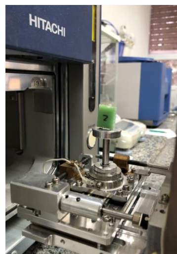
FIGURA 23 – Análise de MEV: (a) Equipamento de MEV, (b) porta amostras.
