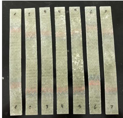
FIGURA 22 – Corpos-de-prova para ensaio de tração.
