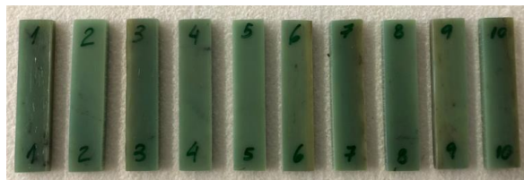
FIGURA 21 – Corpos-de-prova para ensaio de impacto.
