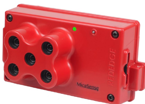
Figura 3.2: Câmera Micasense RedEdge TM utilizada na aquisição das imagens.
