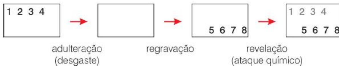
FIGURA 5.5-Uso de agentes reveladores para identificar adulteração em veículo.
