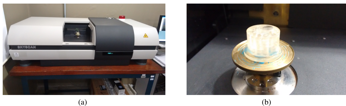
Figura 23 – Imagens do phantom inserido no tomógrafo de alta resolução SkyScan 1172.
