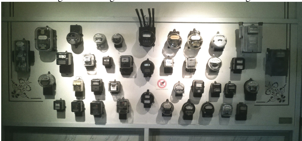
Figura 23: Relógios medidores de consumo de energia
