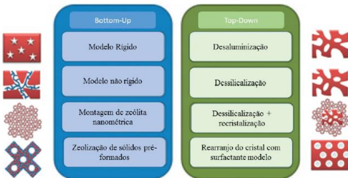
Figura 15: Diferentes tipos de abordagens para a preparação de zeólitas e possíveis estruturas formadas, por estratégias de síntese (Bottom-Up) e pós síntese (Top-Down).
