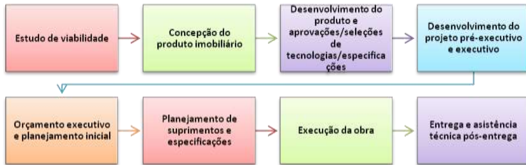
Figura 14 – Etapas para garantir o desempenho dos sistemas com base na NBR 15.575
