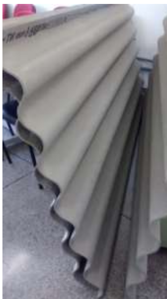
Figura 22 – Telha fibrocimento ondulada
