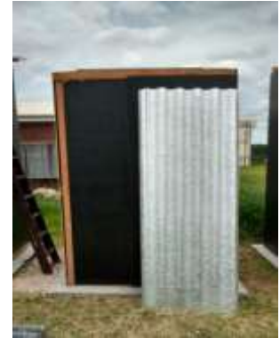
c) Telha com conteúdo reciclado polietileno-Alumínio ondulada. Utilizou-se 2 chapas para cobertura
