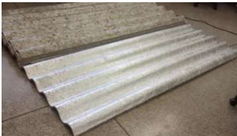
Figura 19 – Telha com conteúdo reciclado de polietileno-alumínio
