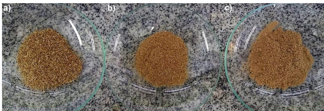
Figura 3 - Bagaço de cevada peneirado em peneiras de 35 (a), 60 (b) e 100 (c) mesh, respectivamente.
