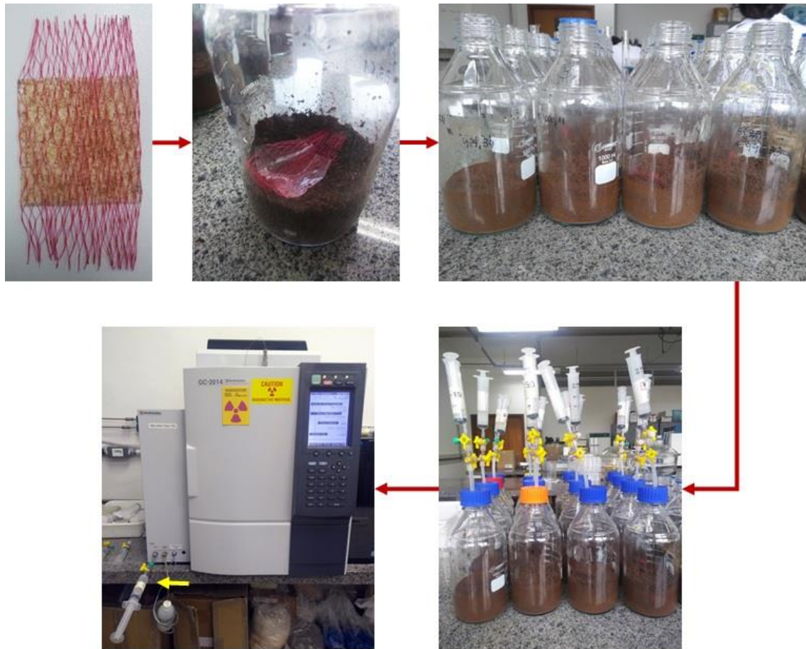
Figura 11 - Sistema de incubação e coleta dos gases.
