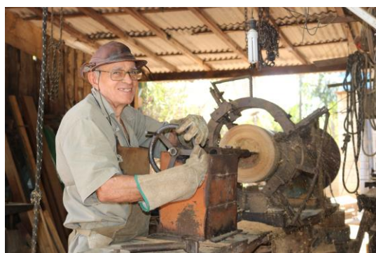
Figura 121 - perfuração da boca do pilão
