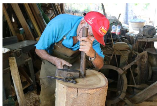
Figura 115 - Marcação do ponto central
