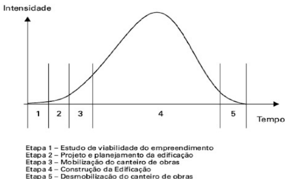
Figura 17. Etapas do Ciclo de Vida de um Projeto de Construção de um Empreendimento na Construção Civil.
