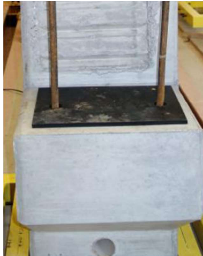
Figura 39 – Detalhe do aparelho de apoio do Ensaio NCE
