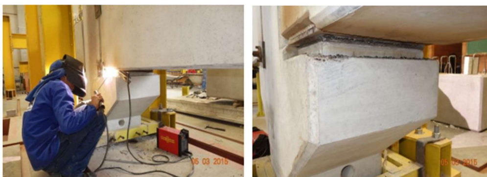
Figura 27 – Solidarização das Chapas Viga-Pilar, ensaio CSE
