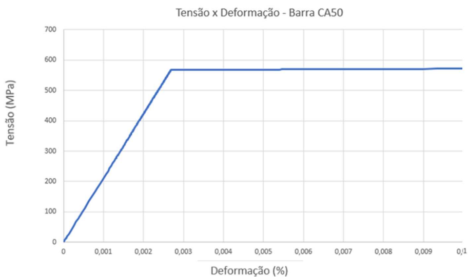
Figura 78 – Curva Tensão-Deformação da barra do negativo (CA50)
