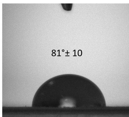
FIGURA 4.17 - Imagem de ângulo de contato da fibra de PCL:PEC:FAU, com 2,5% de zeólita.
