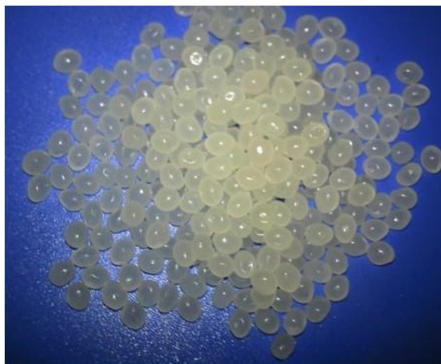
Figura 13: Grânulos do PLA utilizado.
