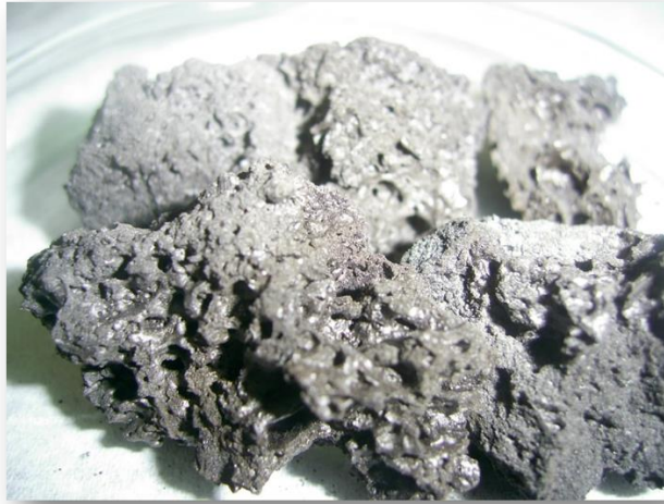
Figura 34: Aspecto do material calcinado a 350°C por 30 minutos.
