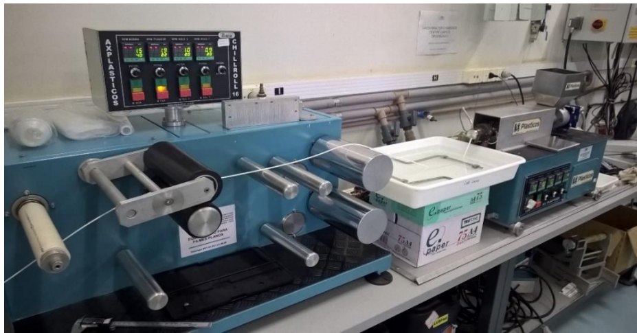
Figura 18: Extrusora de fios de 3 mm com banho de água e rolos.
