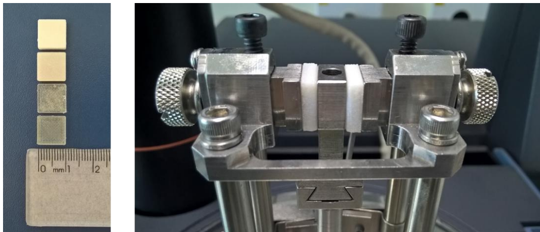
Figura 29: Corpos de prova de alguns compósitos e equipamento realizando o ensaio de cisalhamento.
