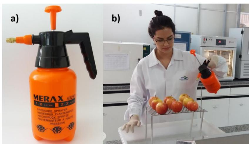
**Figura 2.6** – Processo de revestimento por aspensão. (a) **Pulverizador manual** de pressão (Merax) utilizado para aplicação de Nanopartículas de Quitosana-TPP em maçãs (b) e goiabas.
