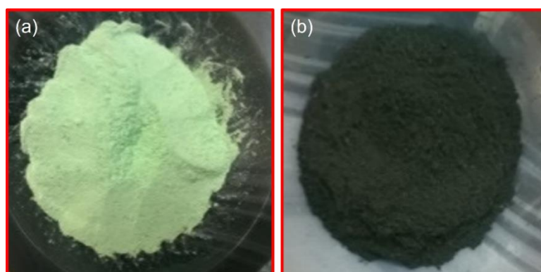
FIGURA 12- Fotografias: (a) Precursores para síntese da fase \text{LaNiO}_3 secos a 100\text{ }^\circ\text{C} por 12 h; (b) \text{LaNiO}_3 calcinado a 900\text{ }^\circ\text{C} por 4 h sob fluxo de oxigênio.
