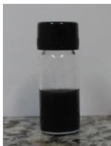
FIGURA 13 - Fotografia representativa da solução de dispersão do eletrocatalisador \text{LaNiO}_3 .
