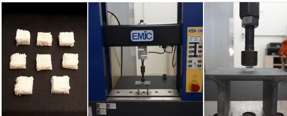
Figura 5 - Ensaio de compressão dos scaffolds .
