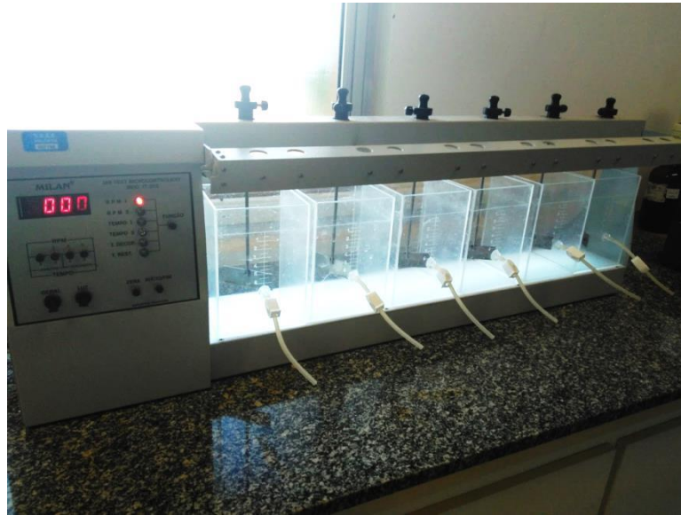
FIGURA 4.1 - Equipamento tipo jartest utilizado para os ensaios de precipitação de estruvita em efluente.
