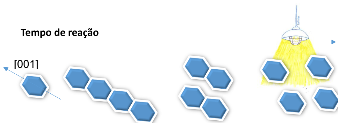
FIGURA 5.2-9 – Esquema demonstrando o efeito do tempo de reação na forma dos nanocristais e a influência da maior exposição das faces dos planos (001) no aumento da degradação da capa orgânica e consequentemente resultando em maior instabilidade dos nanocristais, quando expostos a radiação UV.
