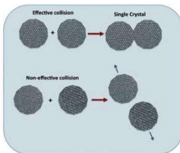
FIGURA 2.3-2 representação de uma efetiva e não efetiva colisão entre partículas. Mecanismo de oriented attachment (11) .
