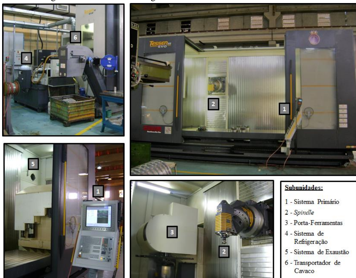
Figura 11 – Centro de usinagem e suas subunidades referentes ao EC-2
