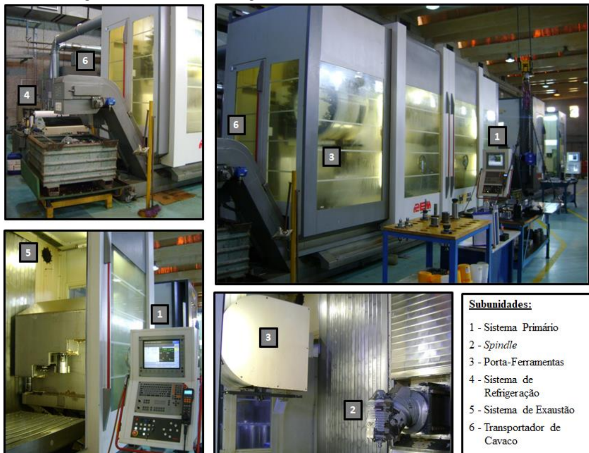
Figura 10 – Centro de usinagem e suas subunidades referentes ao EC-1
