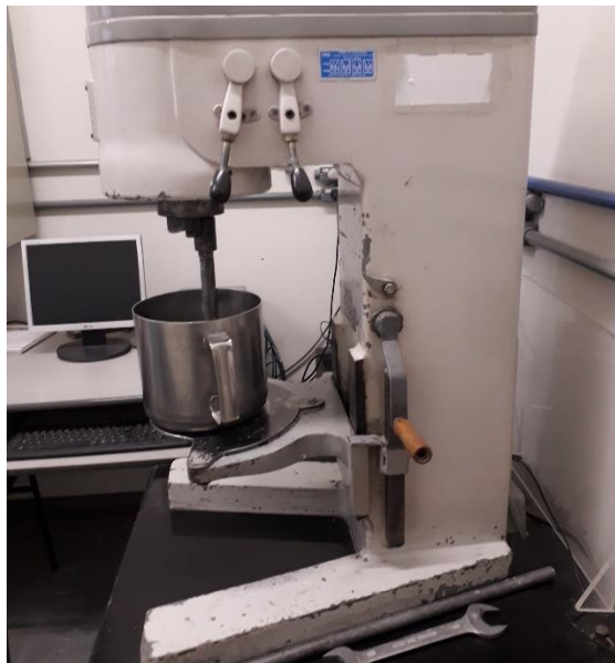
Figura 3.2 - Reômetro utilizado para o processamento dos concretos refratários.
