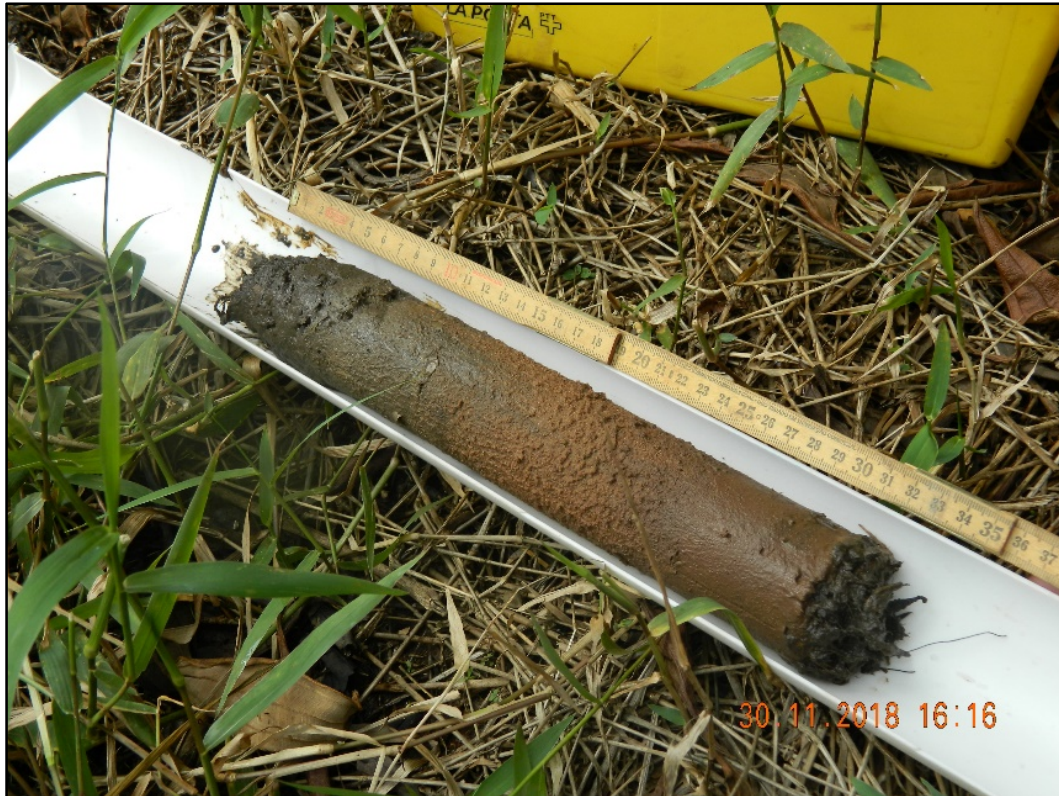
Figura 17 – Disposição da amostra na calha após a coleta, para aferição de profundidade coletada e segmentação em camadas de deposição do sedimento distintas.
