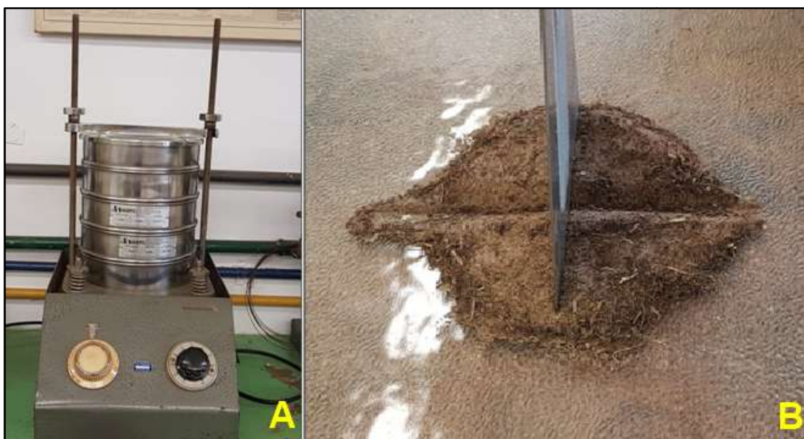
Figura 19 – A: Agitador de peneiras utilizado na triagem das amostras, com as peneiras nº 4, 16 e 200; B: Quarteamento da amostra adotado neste trabalho. Fonte: Autora (2019).
