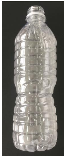
Figura 11. Garrafa utilizada para obtenção dos discos e material moído de PET (Acervo pessoal da autora).
