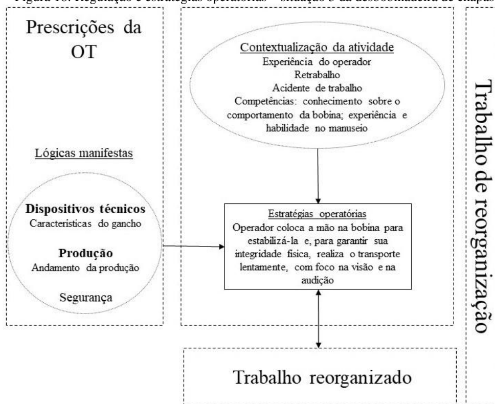
Figura 18: Regulação e estratégias operatórias – situação 3 da desbobinadeira de chapas
