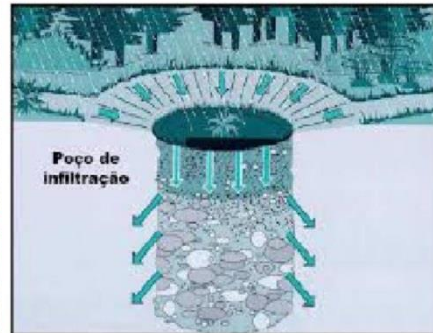
Poço de infiltração
