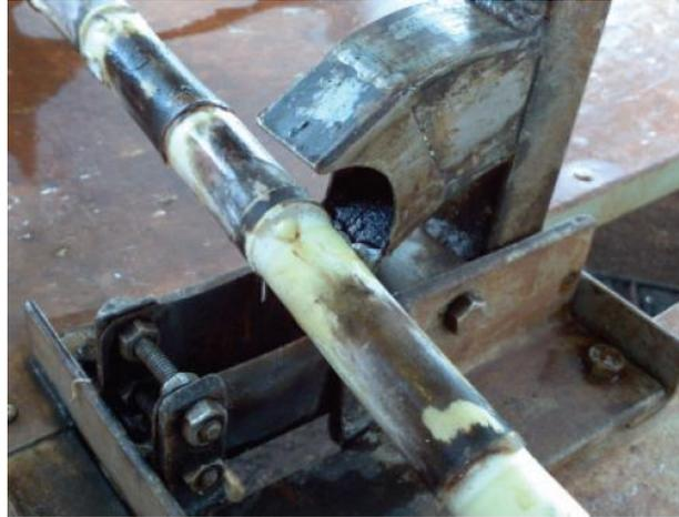
**Figura 04.** Corte de minirrebolos de cana-de-açúcar em guilhotina de lâmina dupla.
