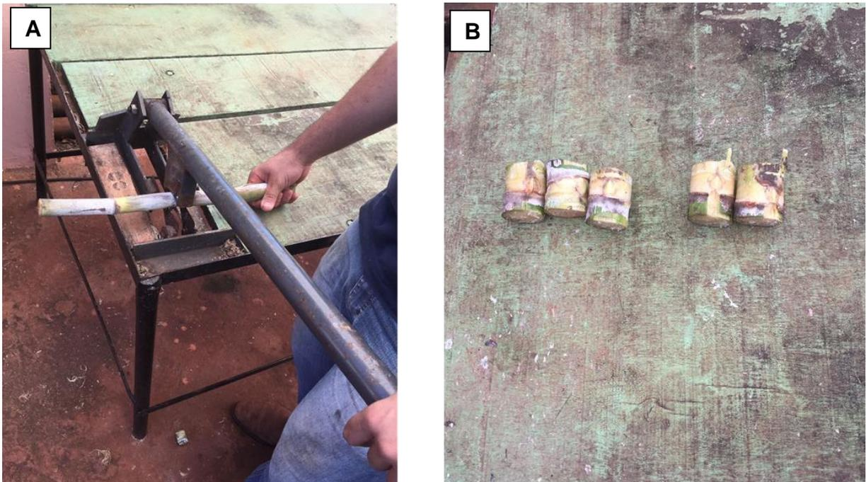
**Figura 15.** Sistema de guilhotina para corte de minirrebolos de cana-de-açúcar (a) e seleção das melhores gemas (b).
