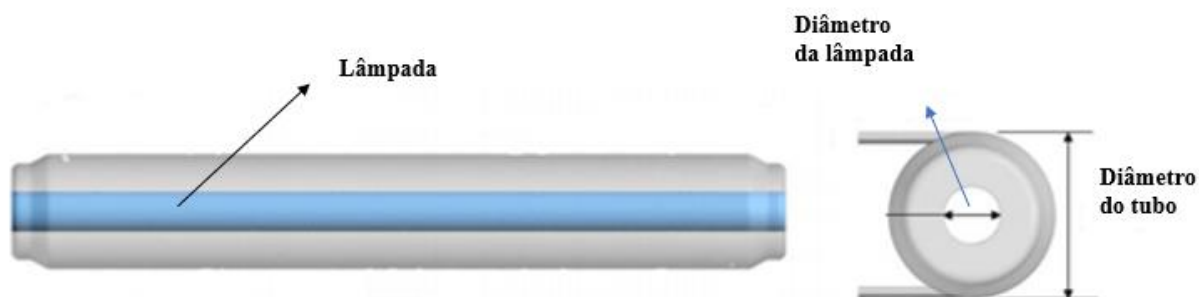
Figura 14 – Esquema simplificado de um reator fotoquímico tubular anular.
