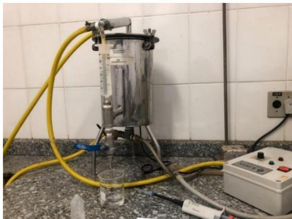
**Figura 4.** Hidrodestilador (Cordeirópolis/SP, 2018/2019).
