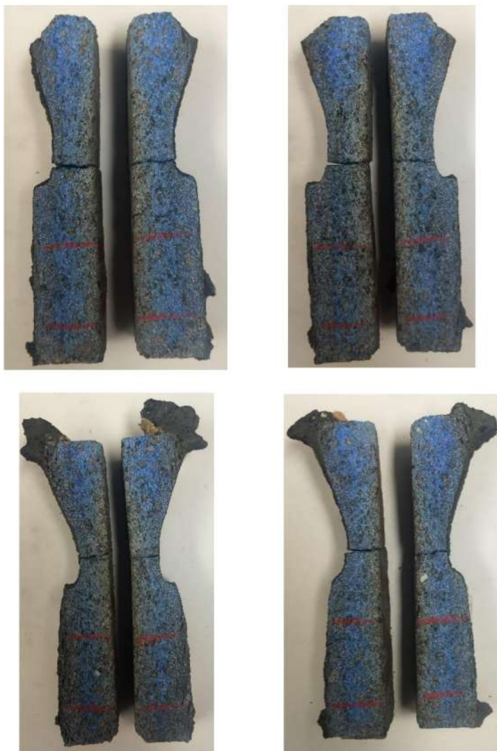
Figura 20: Corpos de prova da composição ADV após o teste de escorificação em forno de indução.
