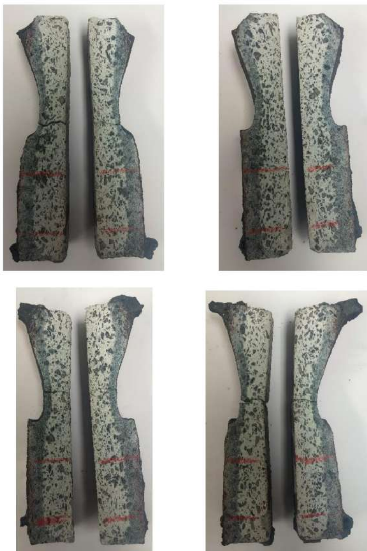
Figura 19: Corpos de prova da composição REF após o teste de escorificação em forno de indução.
