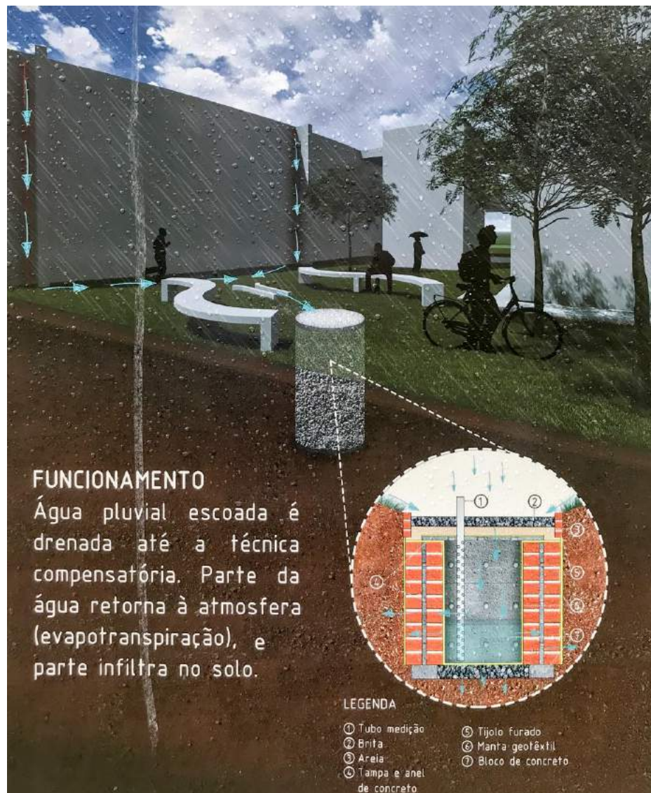
Figura 24 - Composição do sistema valeta-poço de infiltração construído pelo G-HIDRO, no campus da UFSCar, em São Carlos/SP.
