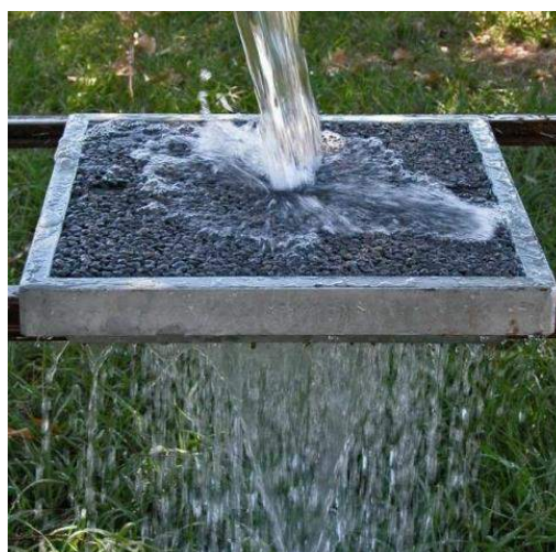
Figura 16 - Concreto permeável desenvolvido por pesquisadores da Universidade Federal do Rio Grande do Sul.
