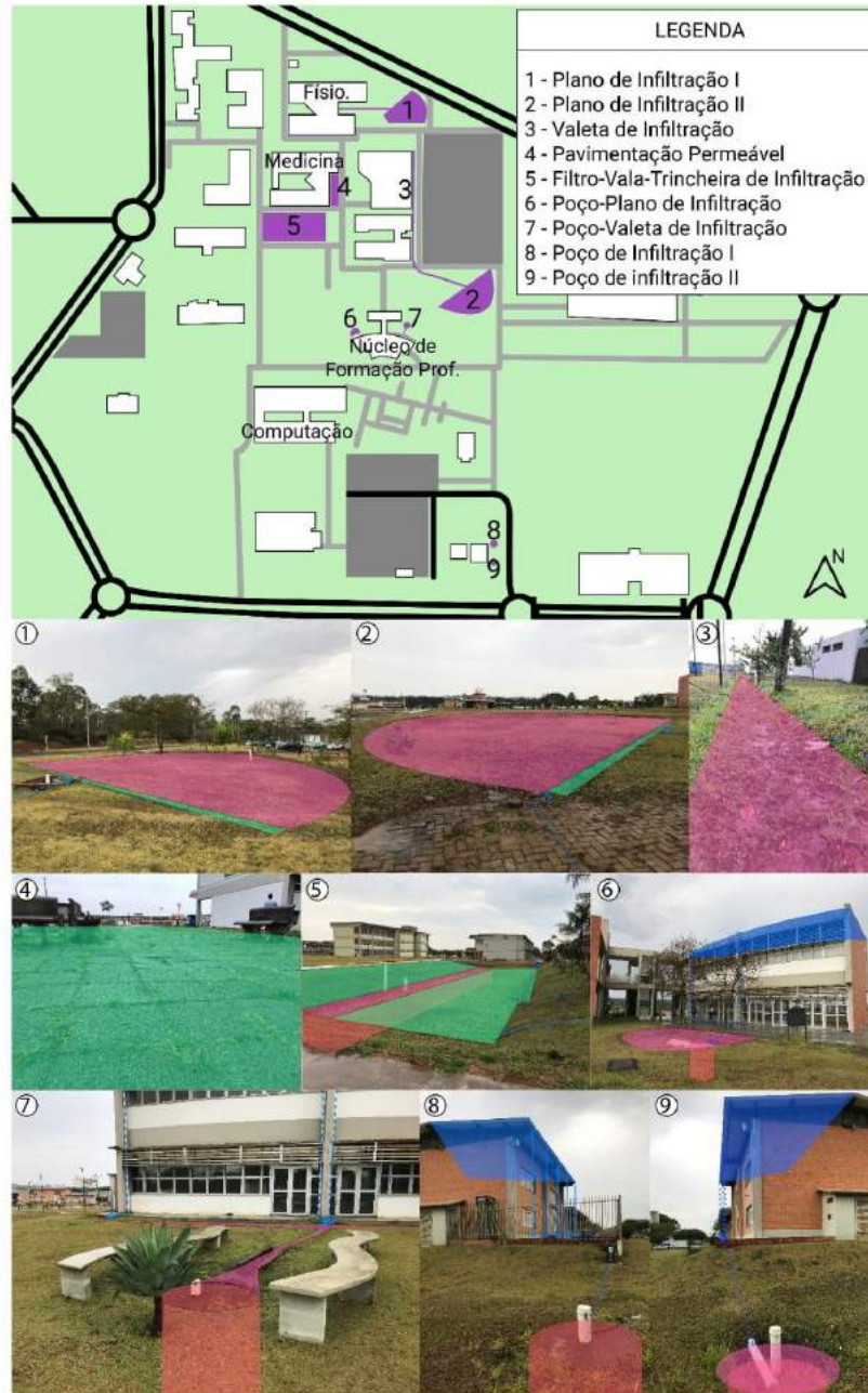
Figura 2 - TCs construídas no campus da UFSCar, microbacia experimental na Área Norte, em São Carlos/SP.
