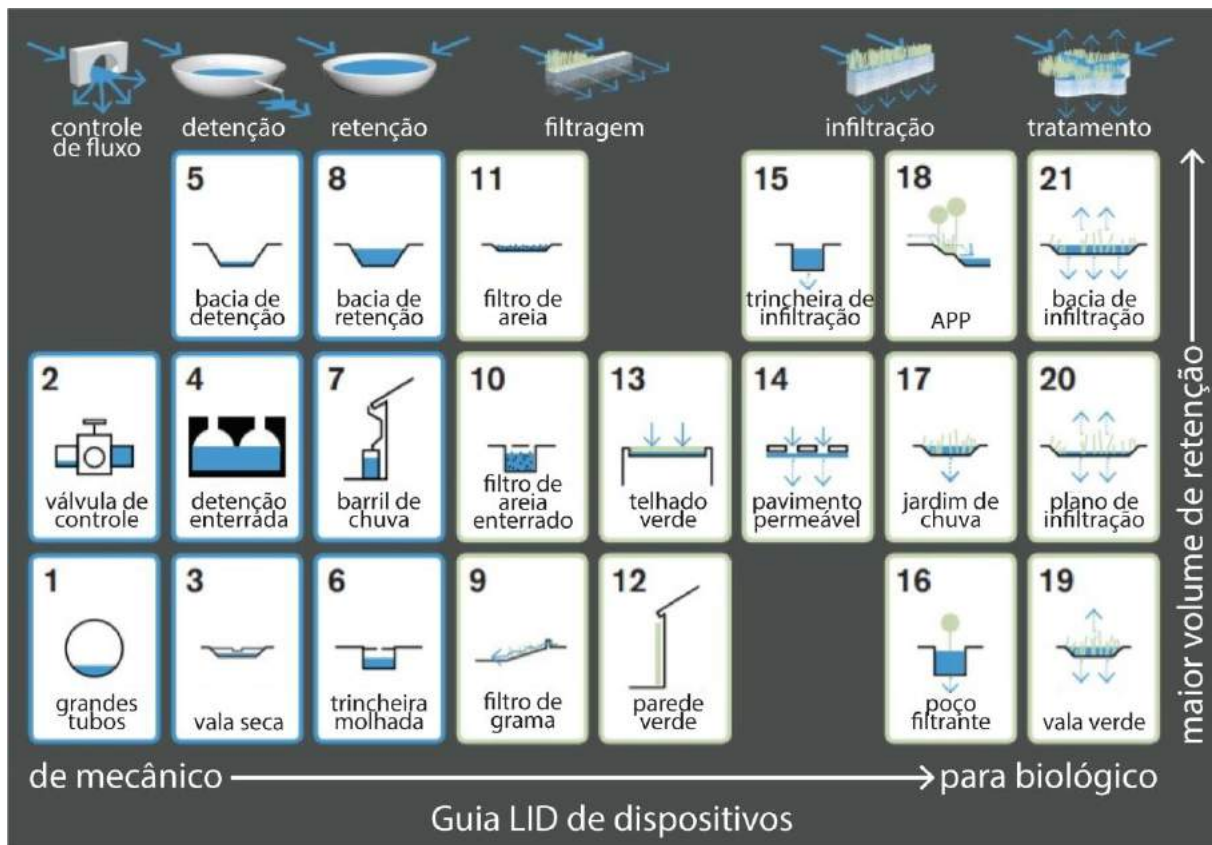
Figura 2 - Comparação de sistemas mecânicos (tradicionais) e biológicos.
