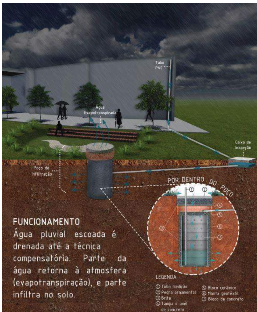
Figura 22 - Composição do sistema plano-poço de infiltração construído pelo G-HIDRO, no campus da UFSCar, em São Carlos/SP.
