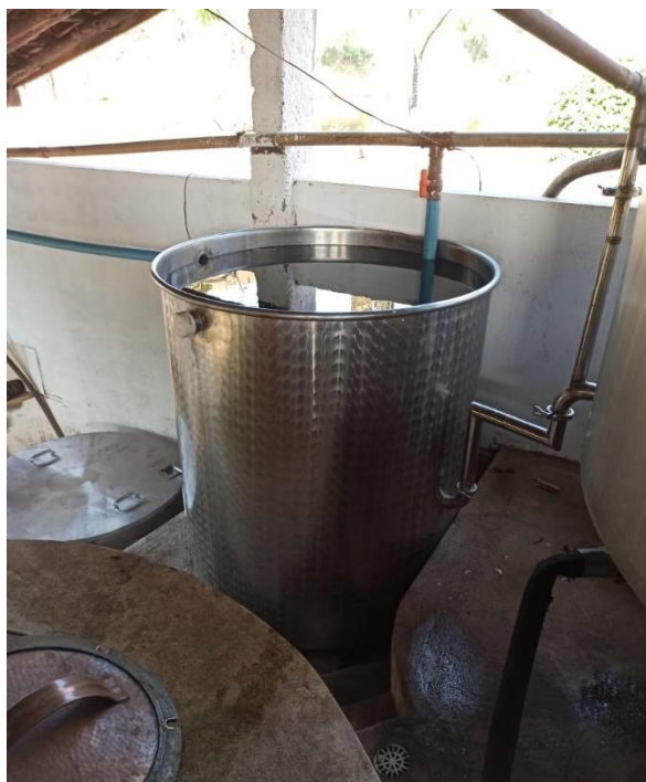
Figura 3.11: Serpentina responsável pela condensação da aguardente
