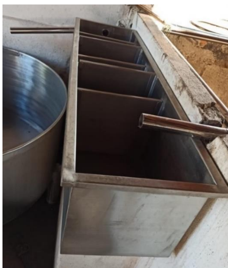
Figura 3.7: Decantador utilizado no processo
