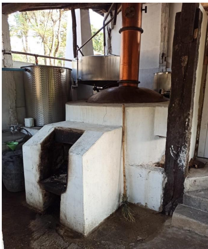
Figura 3.10: Alambique utilizado no processo
