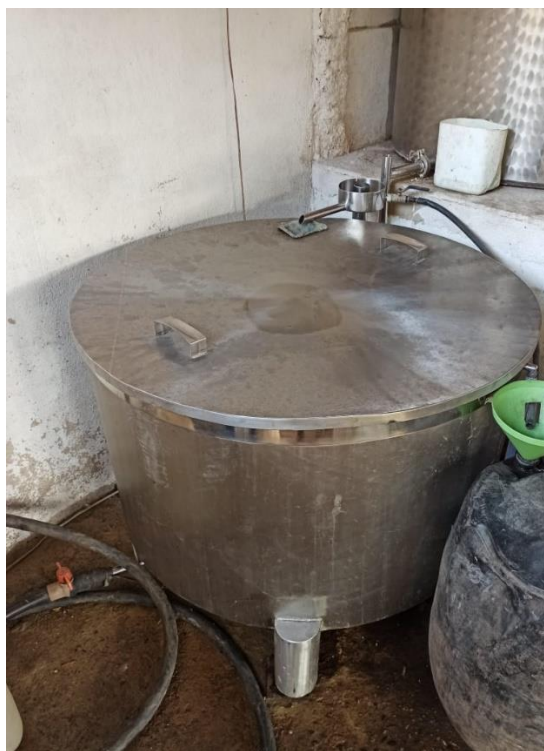
Figura 3.12: Tanque de recebimento da aguardente
