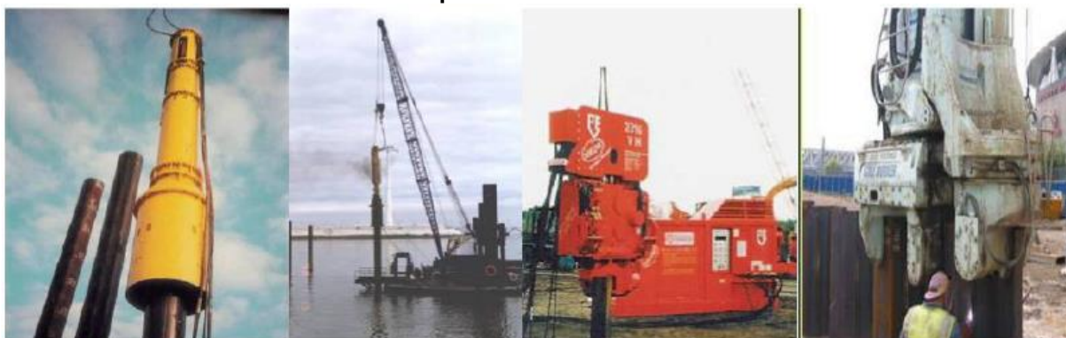
Figura 36 – Da esquerda para a direita: martelo hidráulico, martelo a diesel, martelo vibratório e prensa hidráulica
