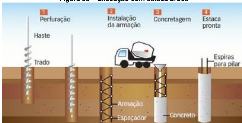
Figura 38 – Execução com estaca broca
