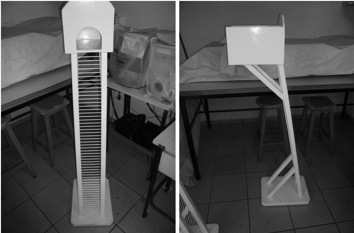
Figura 4. Escada de madeira utilizada no protocolo de treinamento resistido. Contém 110 cm de altura com degraus de ferro e inclinação de 80 graus. Vista frontal (painel à esquerda) e vista lateral (painel à direita).
