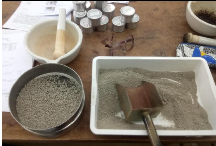
Figura 24- Início do peneiramento grosso: amostra de solo retida na peneira #10.
