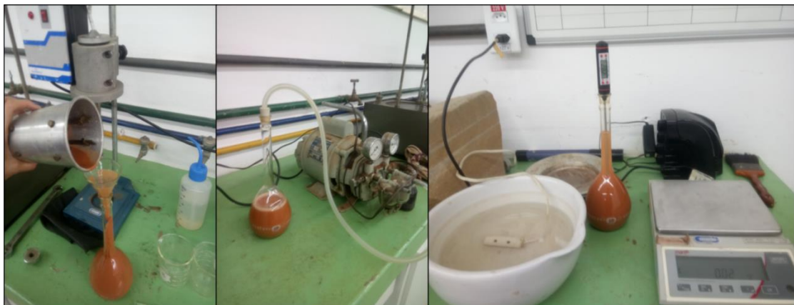
Figura 33- Determinação da massa específica do solo. a) Transferência da amostra do solo para o picnômetro; b) Aplicação de vácuo ao picnômetro contendo a amostra, e c) Determinação da massa do picnômetro contendo as amostras do solo e água, para várias temperaturas.
