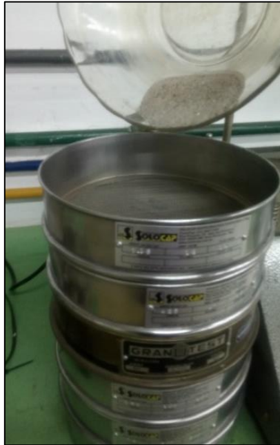
Figura 28- Amostra de solo distribuída no conjunto de peneiras para material fino.
