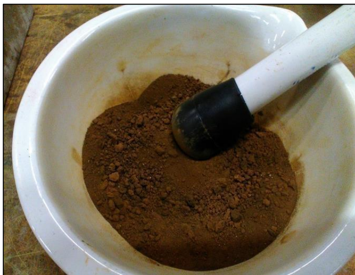
Figura 23 – A almofariz e mão de borracha, no processo de destorroar o solo.
