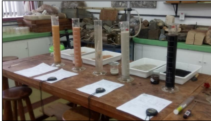
Figura 32 – Amostras de solos em equilíbrio durante intervalo de medição de material suspenso com o densímetro.
