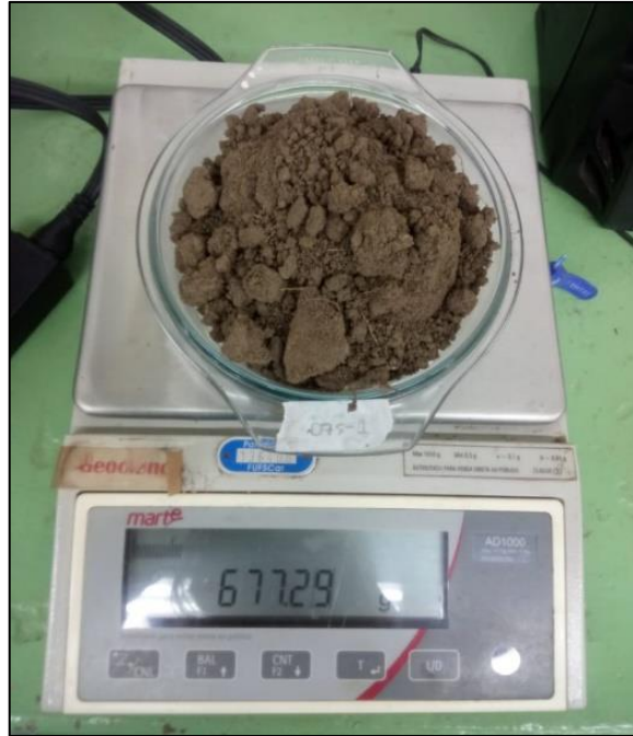
Figura 21 – Pesagem de fração de amostra para cálculo de umidade higroscópica ao ar.
