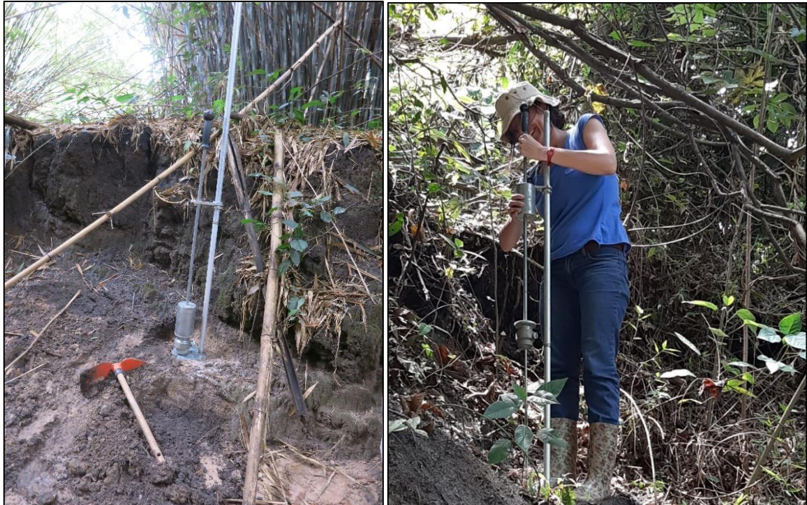
Figura 20 – Execução do ensaio in situ de resistência à penetração.
