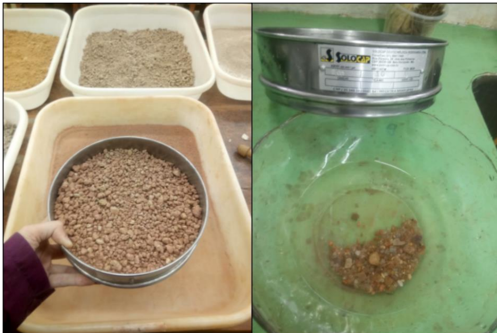
Figura 25- Porção de amostra de solo retida na peneira #10 lavada, para posterior secagem na estufa.
