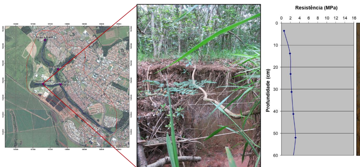
Figura 58 - Ensaio de resistência à penetração no material “Coluvionar”, testado no ponto 075. Com gráfico do resultado da resistência, expressado em MPa.
