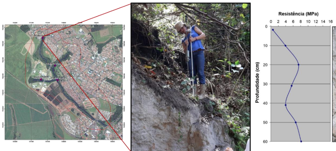
Figura 61- Ensaio de resistência à penetração na camada cinza do material “Hidromórfico” no ponto 081-B. Com gráfico do resultado da resistência, expressado em Mpa.
