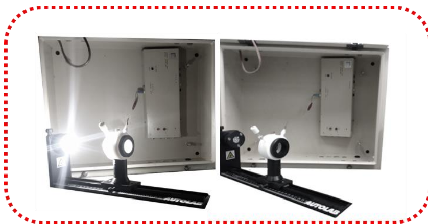
FIGURA 6: Representação do sistema on/off composto por uma régua para a inserção da célula eletroquímica em direção ao LED e uma caixa para evitar interferências externas.
