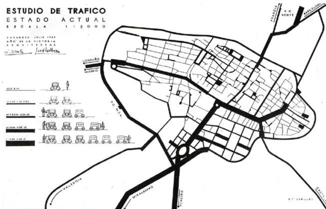
Figura 11: Estudo de tráfego de 1939 estudo da quantidade de automóveis por via.
