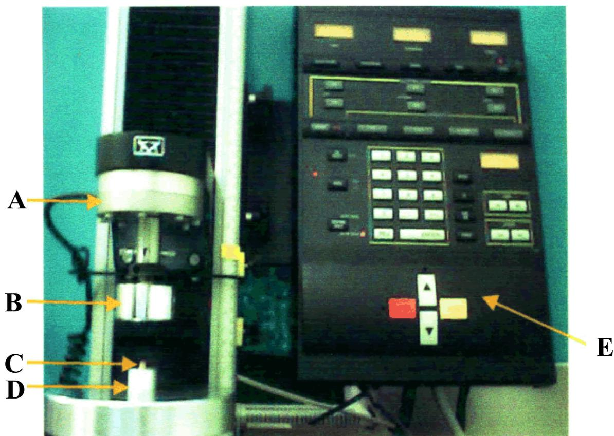
**Figura 1.** Foto da máquina de ensaio universal Instron (modelo 4444) demonstrando um teste de compressão da vértebra de rato. A: célula de carga de 1kN; B: haste com superfície plana; C: vértebra L<sub>5</sub>; D: suporte com base plana; E: painel de controle.
