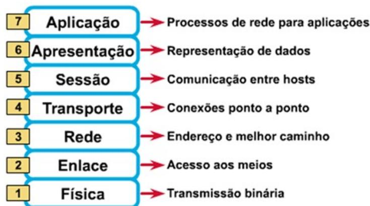
Figura 9 – Camadas definidas pelo modelo OSI para protocolos de comunicação (DLTEC, 2011).
