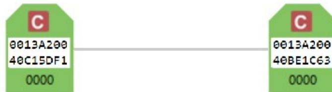
Figura 43 – Topologia do projeto, com dois módulos XBee em comunicação ponto-a-ponto.
