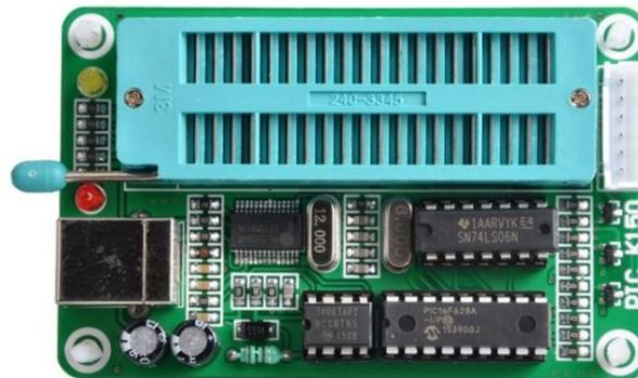
Figura 24 – Modelo gravador programador de PIC (AUTOCORE, 2020).
