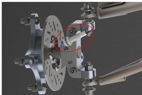
Figura 12 – Montagem do sensor indutivo em uma das rodas do carro.
