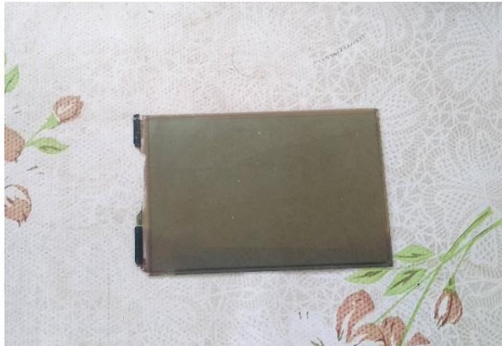
Figura 48 - Filtro polarizador de tela de celular.
