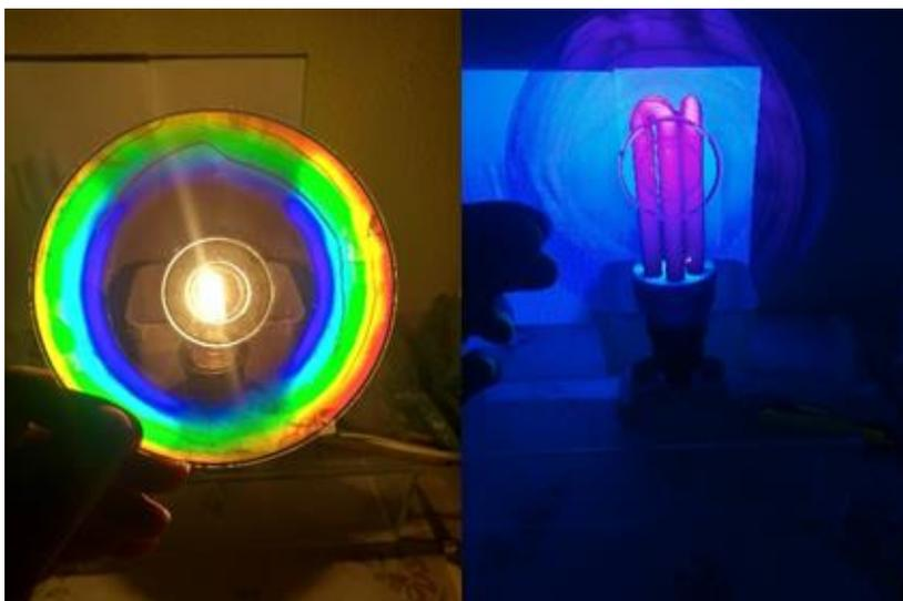
Figura 17 - Cada fonte de luz tem determinados comprimentos de ondas ou frequências que enxergamos como cores, ao incidir a luz dessas fontes no CD essas frequências são dispersadas pela rede de difração e aparecem as cores existentes nessas fontes.
