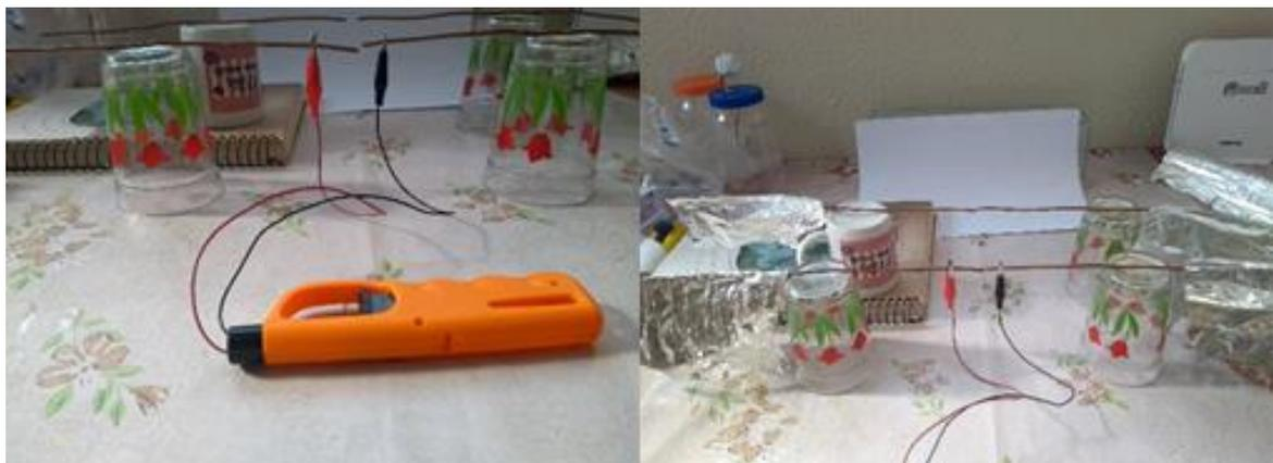
Figura 44 - Construção do experimento com as quatro hastes de fio de cobre rígidos, lâmpada de néon, papel alumínio para antena e dispositivo piezoelétrico para gerar carga.
