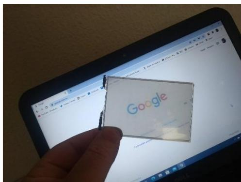
Figura 26 - Película polarizada retirada da tela de um celular sem uso.
