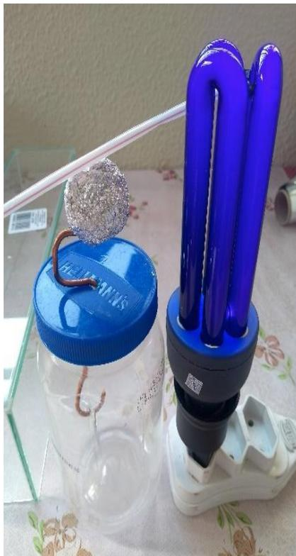
Figura 59 - Ao posicionar uma lâmpada de luz negra de radiação ultravioleta com energia suficiente, os elétrons são arrancados do eletroscópio, mesmo o canudinho ainda tocando o papel alumínio.
