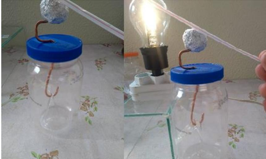
Figura 58 - O canudinho atritado com o papel toalha fica carregado com cargas negativas, ao tocar com o canudinho no papel alumínio, os elétrons fluem para a parte inferior do eletroscópio, esses elétrons se repelem separando as fitas de papel alumínio, e mesmo exposto a uma lâmpada incandescente, não há alteração aos elétrons, a energia da lâmpada não é suficiente para arrancar esses elétrons.
