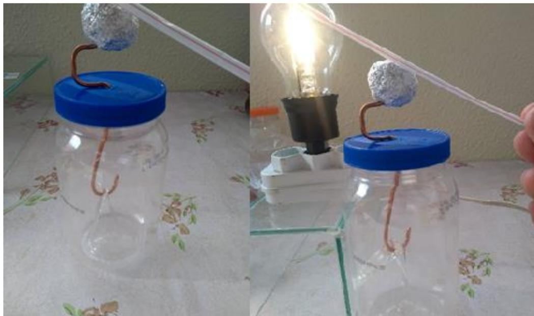
Figura 37 - O canudinho atritado com o papel toalha fica carregado com cargas negativas, ao tocar com o canudinho no papel alumínio, os elétrons fluem para a parte inferior do eletroscópio, esses elétrons se repelem separando as fitas de papel alumínio, e mesmo exposto a uma lâmpada incandescente, não há alteração aos elétrons, a energia da lâmpada não é suficiente para arrancar esses elétrons.
