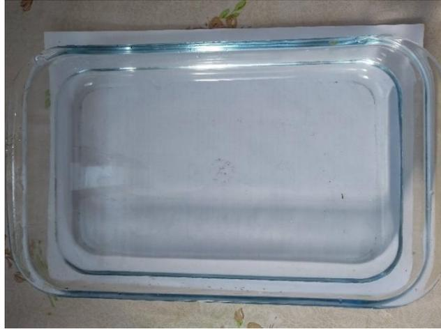
Figura 30 - Travessa de vidro com água para o experimento dos fenômenos de difração e interferência.
