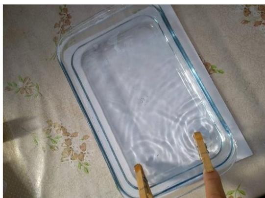
Figura 10 - A perturbação na água em dois pontos gera ondas que irão sofrer interferências.
