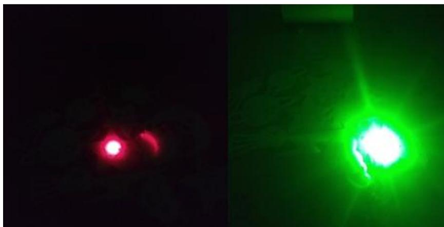
Figura 32 - Os lasers vermelho e verde estão sendo incididos no material fosforescente, porém ambos não têm energia suficiente para excitar os átomos do material.
