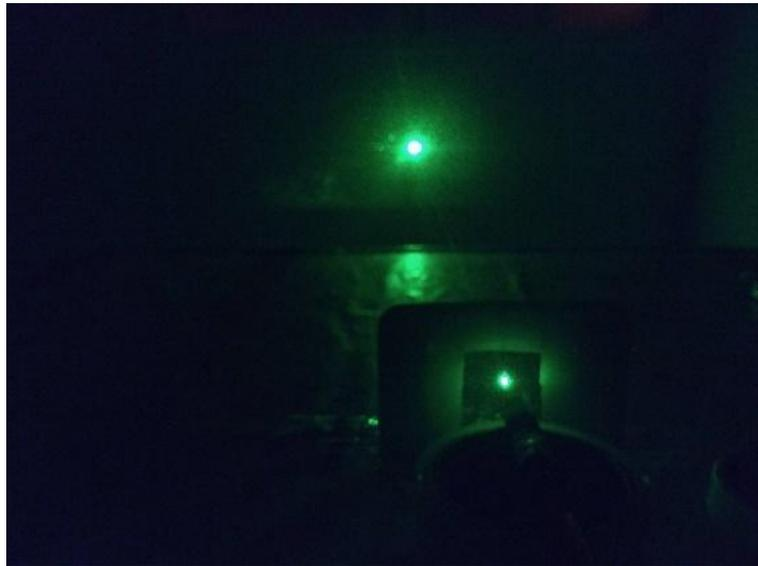
Figura 35 - Verificação dos fenômenos ondulatórios de difração da luz ao passar pelo fio e sua interferência pelo padrão de franjas claras e escuras no anteparo.
