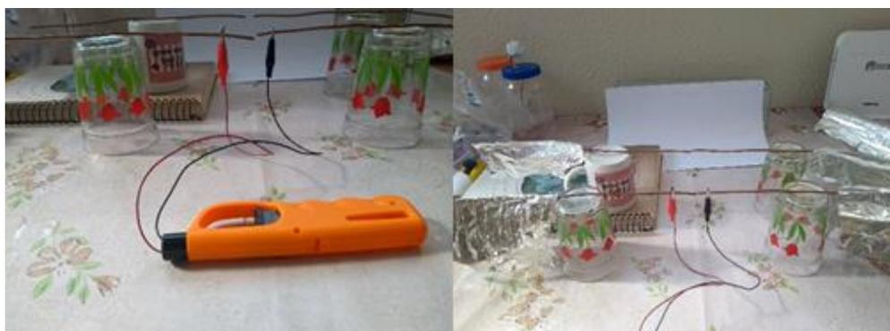
Figura 23 - Construção do experimento com as quatro hastes de fio de cobre rígidos, lâmpada de néon, papel alumínio para antena e dispositivo piezoelétrico para gerar carga.
