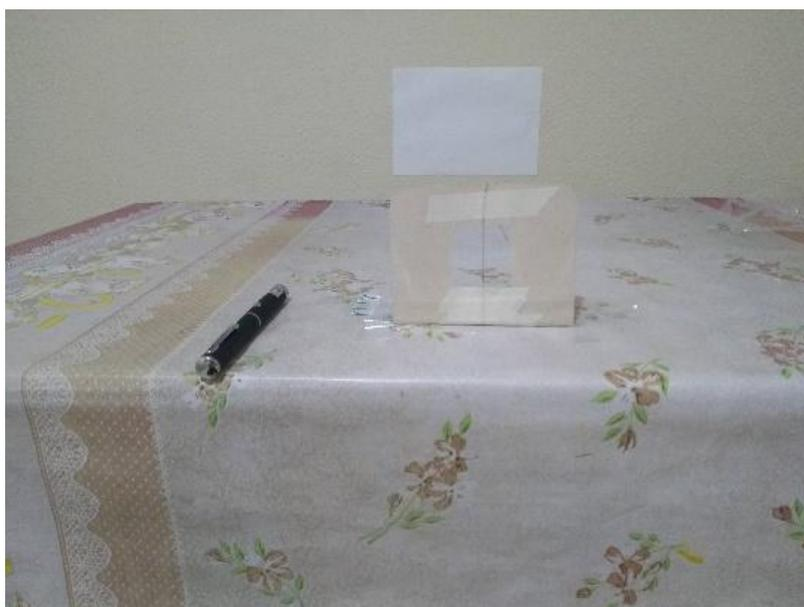
Figura 13 - Experimento montado para a verificação dos fenômenos ondulatórios da luz, difração e interferência.
