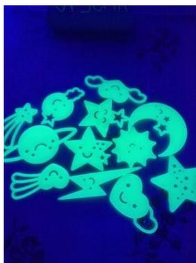
Figura 50 - Material fosforescente excitado por uma lâmpada de luz negra com radiação ultravioleta.
