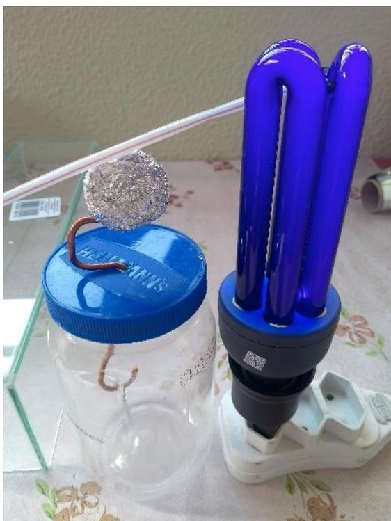
Figura 38 - Ao posicionar uma lâmpada de luz negra de radiação ultravioleta com energia suficiente, os elétrons são arrancados do eletroscópio, mesmo o canudinho ainda tocando o papel alumínio.
