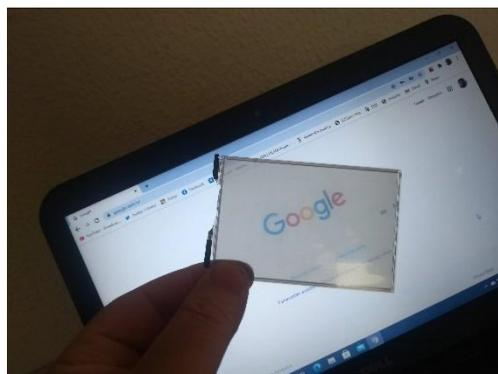
Figura 47- Película polarizada retirada da tela de um celular sem uso.
