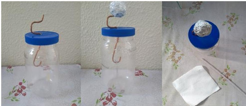
Figura 57 - Montagem do eletroscópio com pote plástico, fio de cobre, pedaço de papel alumínio, canudinho e papel toalha.
