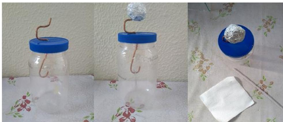
Figura 36 - Montagem do eletroscópio com pote plástico, fio de cobre, pedaço de papel alumínio, canudinho e papel toalha.
