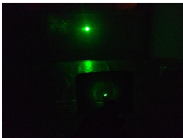
Figura 11 - Raio de luz do laser passando pelo fio de cabelo e resultando em um padrão de interferências.
