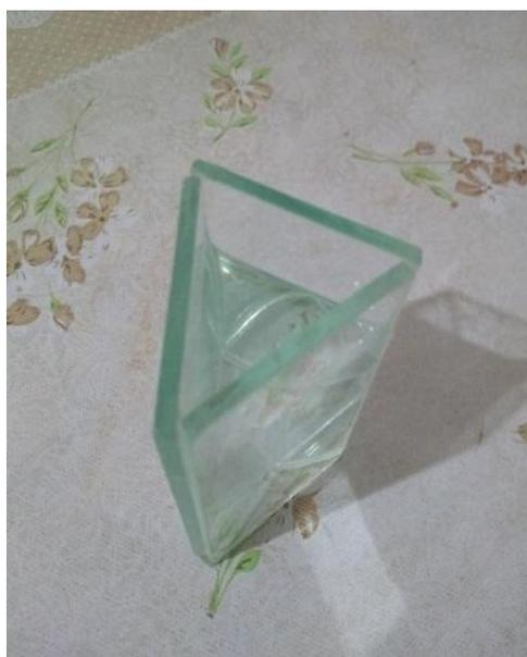
Figura 4 - Prisma de vidro com água para o experimento de dispersão da luz.
