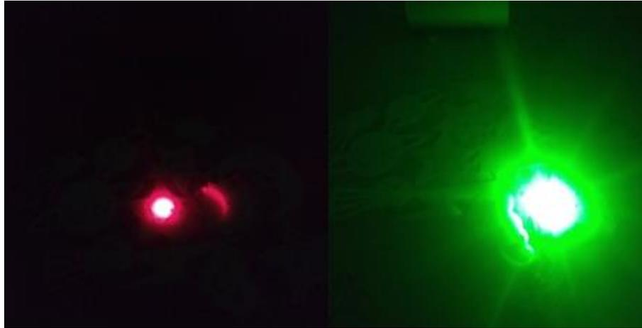
Figura 53 - Os lasers vermelho e verde estão sendo incididos no material fosforescente, porém ambos não têm energia suficiente para excitar os átomos do material.
