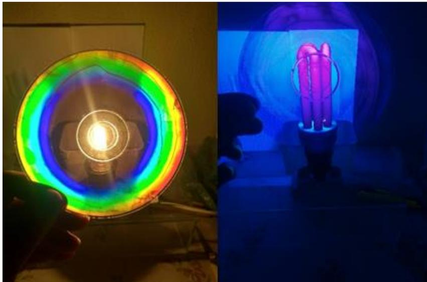
Figura 38 - Cada fonte de luz tem determinados comprimentos de ondas ou frequências que enxergamos como cores, ao incidir a luz dessas fontes no CD essas frequências são dispersadas pela rede de difração e aparecem as cores existentes nessas fontes.
