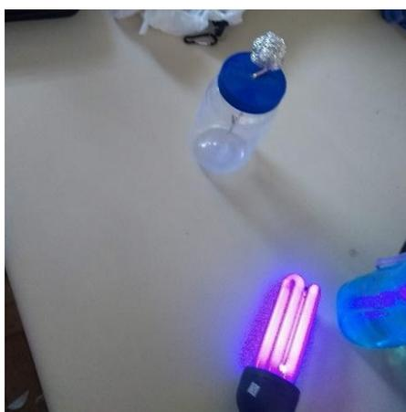
Figura 34 - Experimento do eletroscópio para demonstrar o efeito fotoelétrico.
