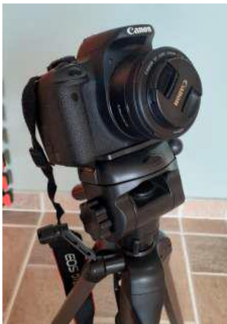
Figura 6.1 – Câmera DSLR utilizada para a captura das imagens montada em um tripé altazimutal.
