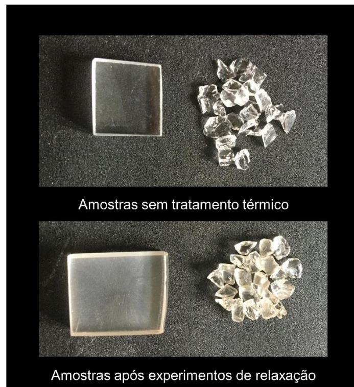
Figura 4.31: Amostras de LS2 utilizadas antes e depois dos experimentos de relaxação via variações de índice de refração e T_g .
